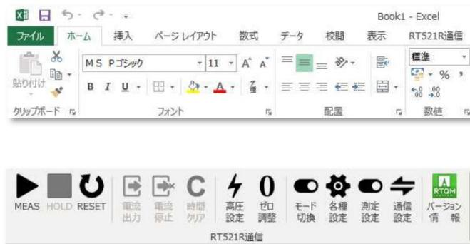
④付属のエクセルアドインで制御と計測値の自動取込が可能です。
