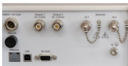
0 \sim \pm 2 nA と 0 \sim \pm 20 nA の 2つの出力端子があります (画像は RT521R2 型電位計)
