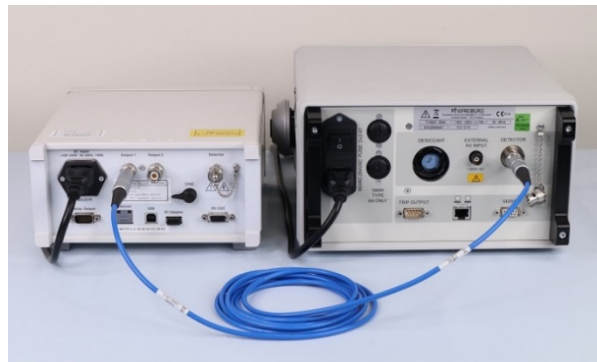
RT521R型の電荷発生装置を他の電位計へ接続した例
